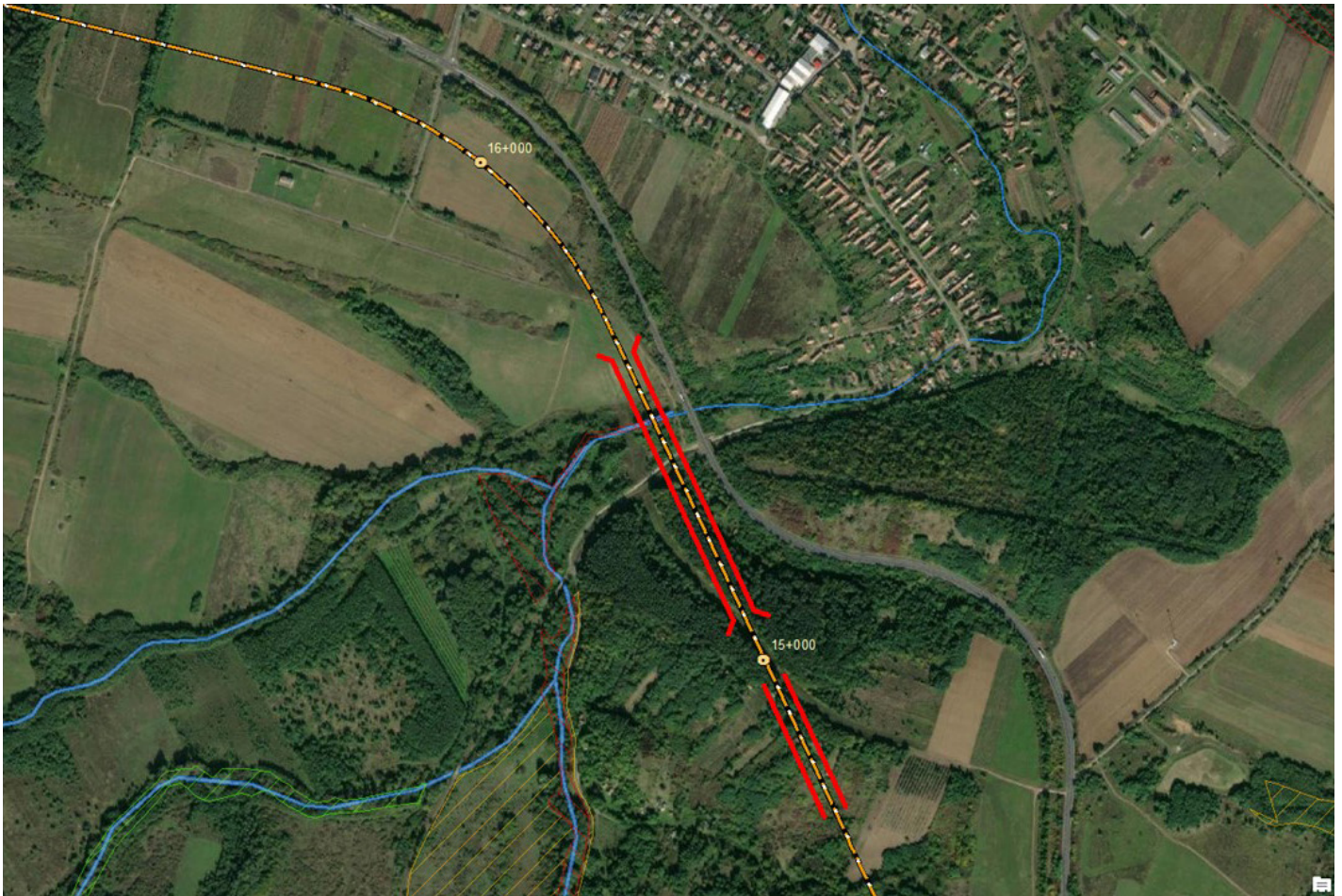
23. ábra: Egy tervezett aluljáróval és támfallal az M2-es gyorsforgalmi út keresztezi a Hévíz-patakot ©MATE
