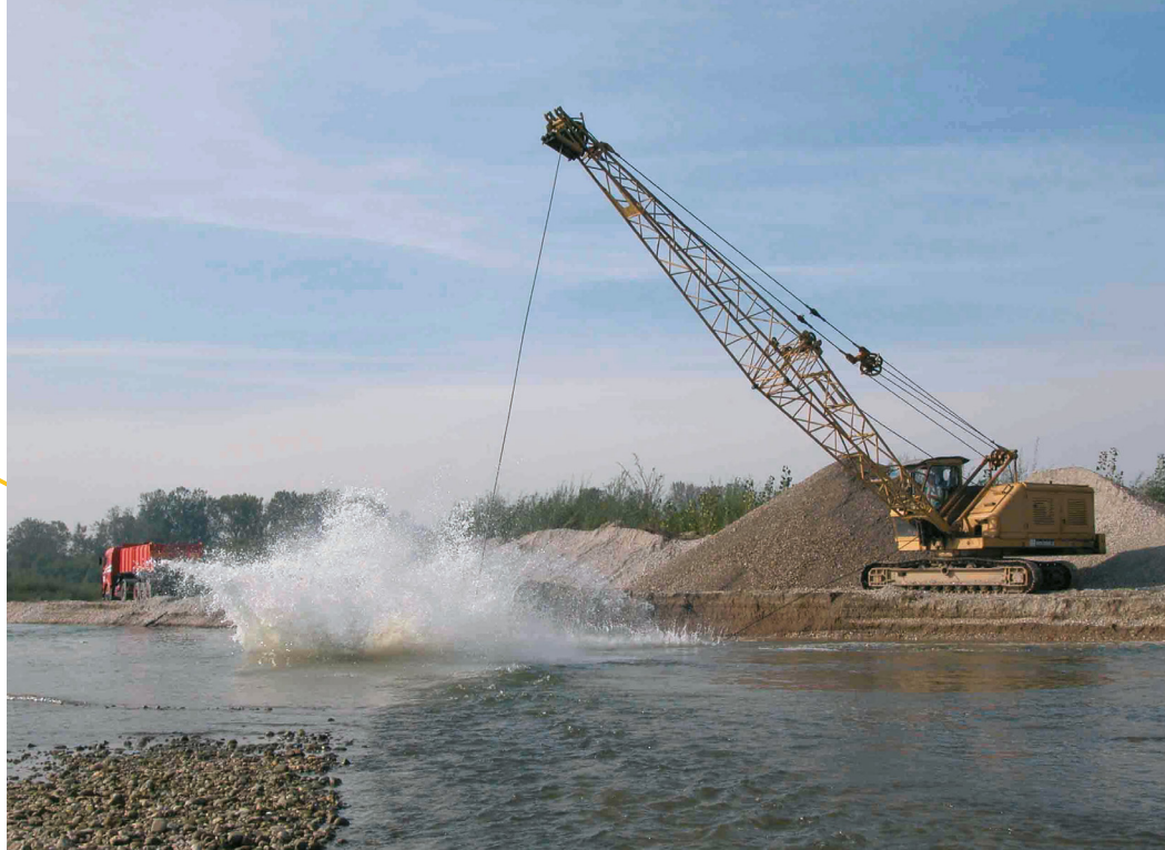
Slika 17. Izkopavanje prodnatih naplavin iz rečne struge
