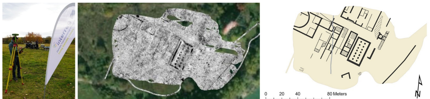
Fotografije LBI ArchPro : Slika lijevo: Postavljanje GPR sustava u Százhalombatti ; Slika sredina: Anketno polje na području rimske tvrđave; Fotografija desno: Interpretacija GPR podataka koji pokazuju rimske građevinske strukture.
