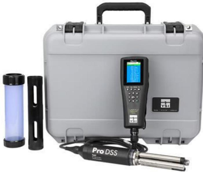
In situ multiparameter probe „YSI ProDSS“
