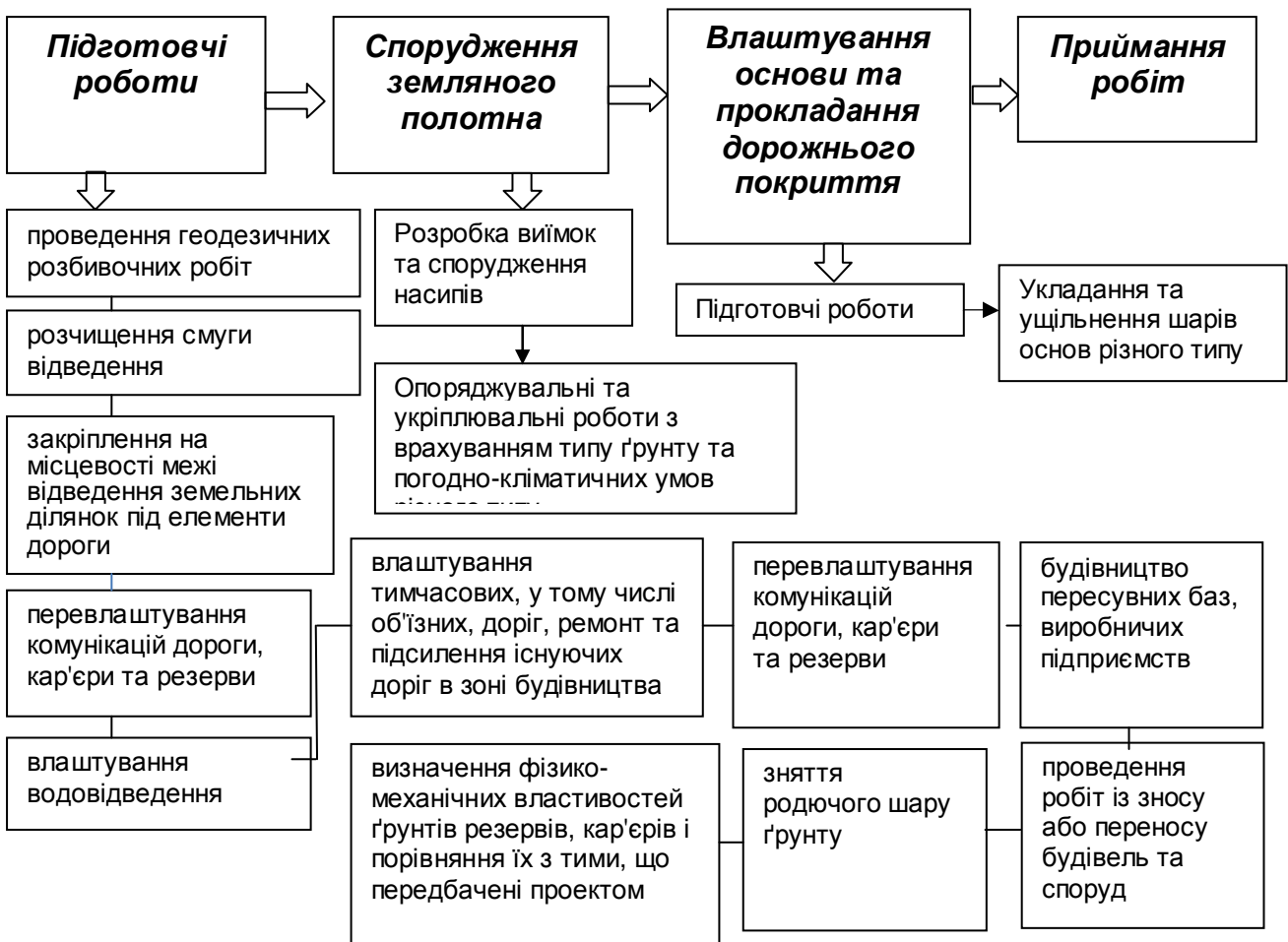
Рисунок 4.1. Основні фази будівництва автомобільних доріг
