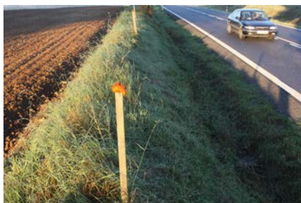
Figura. 120. Mijloacele de descurajare olfactive sunt utilizate în multe zone ale Republicii Cehe. Scopul lor este acela de a avertiza ungulatele de faptul că se află într-o zonă periculoasă, pe care ar trebui să o evite. Cu toate acestea, aceste măsuri de descurajare par a avea doar un efect pe termen scurt. (Foto: Václav Hlaváč)
