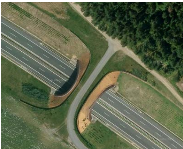
Fig. 35. Utilizarea multifuncțională a podurilor este de obicei soluția preferată în ceea ce privește costurile. De asemenea, este adecvată corelarea funcțiilor pasajelor pentru faună cu cele ale podurilor peste cursurile de apă sau cu ale viaductelor. Altfel, o porțiune mai puțin accesibilă pe o punte verde ar putea fi evitată de către mamiferele mari, ceea ce face ca întreaga măsură să fie nefuncțională. Poprad, Slovacia (Sursă: www.mapy.cz )
